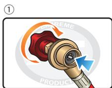
① 缶切りバルブを反時計回りに回し針を最後まで引っ込める。
