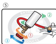
⑤ ①缶切りバルブを時計回りに最後まで回し缶に穴を開ける。
