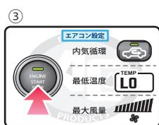
③ エンジンをかけ、エアコン (AC) を内気循環にし、最低温度・最大風量にしてください。
