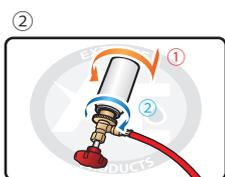
② 缶切りバルブに①COOLMAN をセットし②缶切りバルブのリングを缶に密着するまで締め付けてください。
