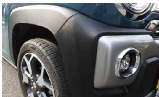
新車購入時の黒々とした未塗装樹脂パーツは、紫外線、熱、雨により PP 素材の分子結合が破壊され、劣化（白化）が進んでいきます。
